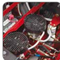
Ventilateurs montés sur les des pompes hydrauliques contribuent au refroidissement de la pompe et repoussent les débris.
