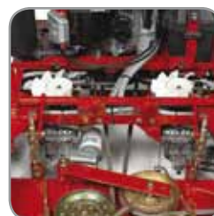
Transmissions doubles indépendantes: ce système hydrostatique mixte à basse pression et entretien réduit améliore la performance et minimise le temps d'immobilisation. Moins de points d'usure et aucun raccordement haute pression pour moins d'entretien.
