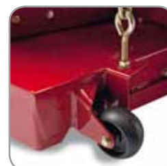
Le plateau est équipé de roues anti-scalp.
