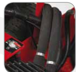
GAINAGE EN CORDURA DES FLEXIBLES HYDRAULIQUE
